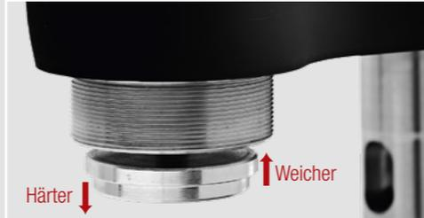
Serienmäßig besitzt eine HD eine sehr weiche Federung der Gabel. Das führt zu schwammigen Fahrverhalten und Instabilität. Bei unseren Gabelbrücken kann man die Federvorspannung um 20mm erhöhen. Somit erhält man ein strafferes, direkteres und sportlicheres Handling des Motorrades. Jeder Fahrer kann seine persönliche Einstellung selbst wählen und vornehmen.
